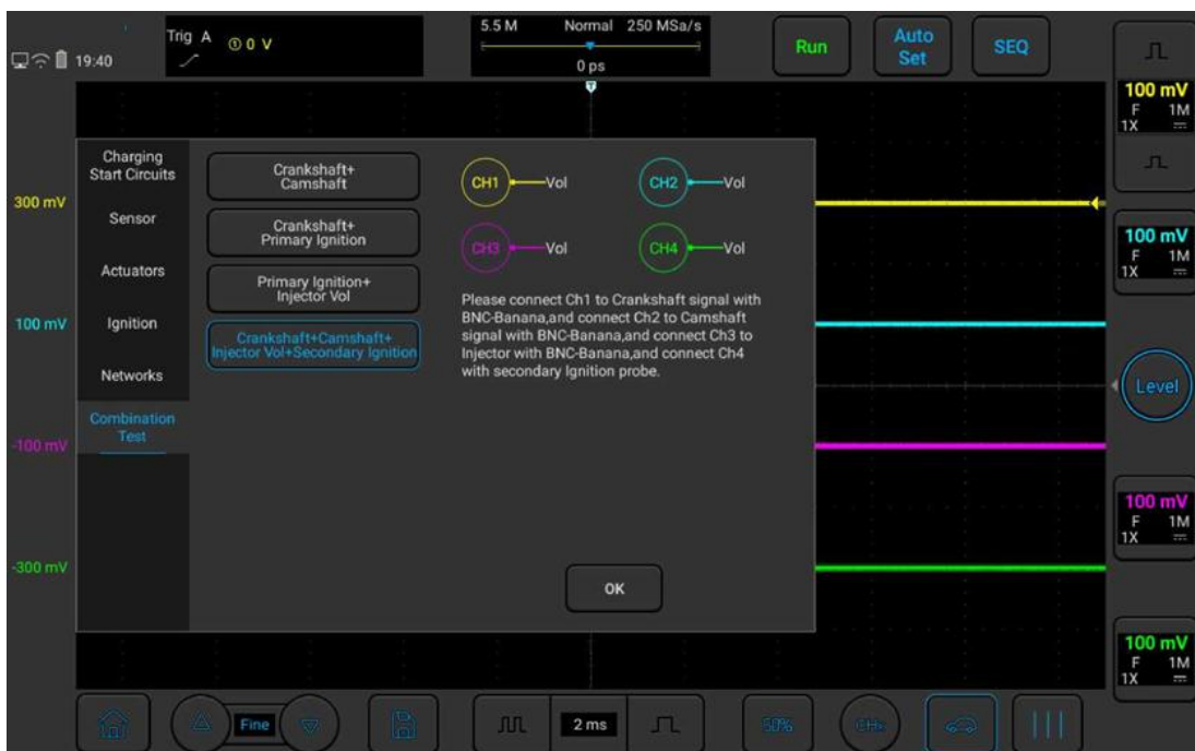
Рисунок 5-14. Комбинированное испытание коленчатого вала + распределительного вала + топливного инжектора + вторичной обмотки системы зажигания
