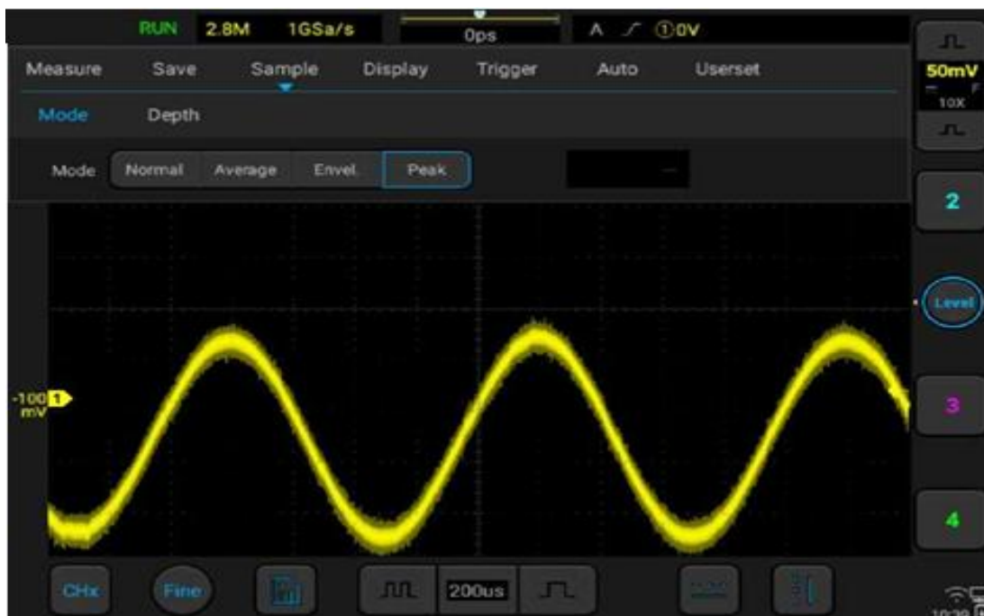
Рисунок 11-6. Синусоида с неровностями. Пиковый режим выборки
