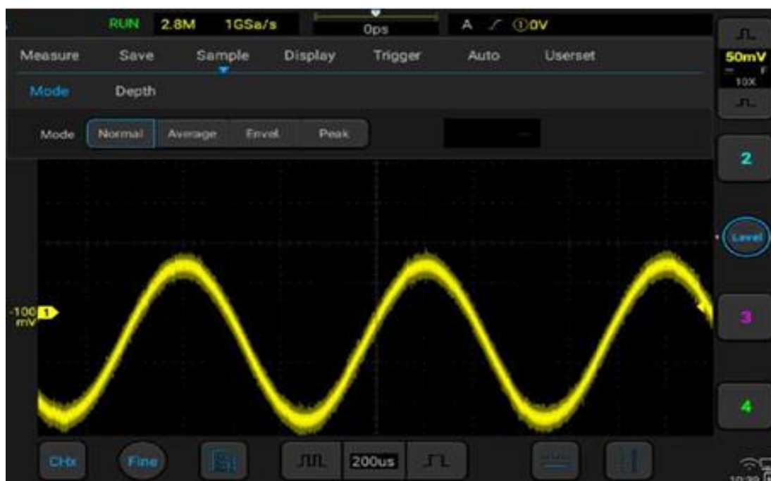
Рисунок 11-5. Синусоида с неровностями. Обычный режим выборки
