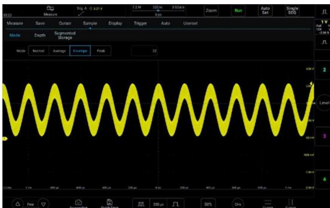
Рисунок 11-8. Сигнал амплитудной модуляции в режиме выборки «Огибающая» (32)
