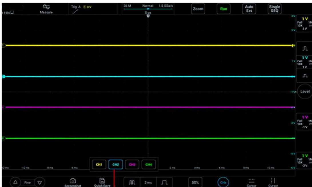
2. Нажмите, чтобы выбрать текущий канал 1. Нажмите кнопку установки текущего канала Рисунок 5-5. Использование кнопки выбора текущего канала
