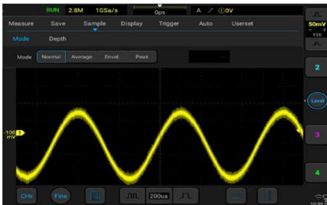
Рисунок 11-5. Синусоида с неровностями. Обычный режим выборки
